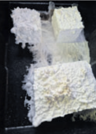
Das Myzel ist das unterirdische, fadenförmige Wurzelgeflecht eines Pilzes und bildet dessen eigentlichen, oft riesigen Hauptteil. Zusammen mit einem organischen Substrat kann es ein Baustoff für die Zukunft werden Foto: au
