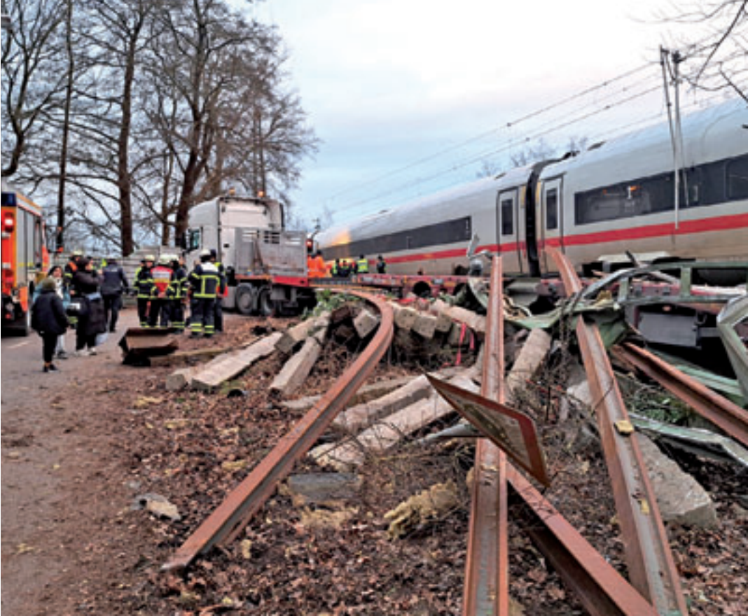
Laut Eisenbahnunfalluntersuchungs-Bericht hätte die Deutsche Bahn wissen können, dass der Bahnübergang zu eng ist für lange Fahrzeuge Foto: sl
