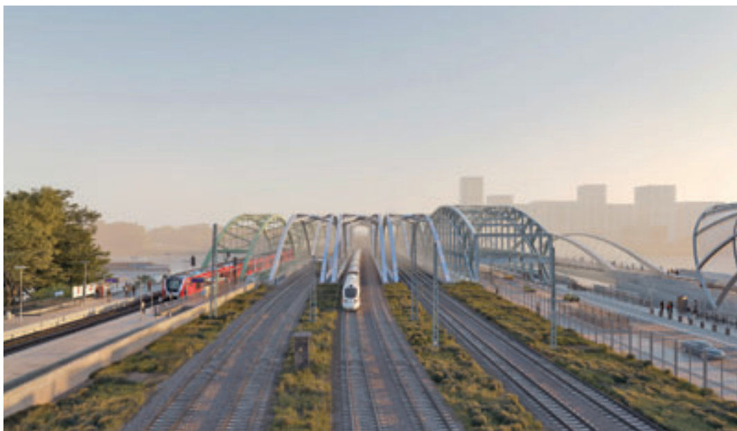
Derzeit führen vier Gleise auf 300 Metern über die Norderelbe, mit der Erneuerung sollen es dann sechs werden Foto: Planungsgesellschaft panta-NEY mbH
