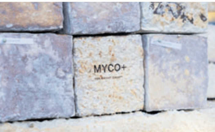
Kann das Wurzelgeflecht der Pilze, das Myzel, das mit organischem Substrat zu einem rein biologischen Verbundmaterial verwächst, ein Baustoff für die Zukunft sein? Fotos: Martha Starke
